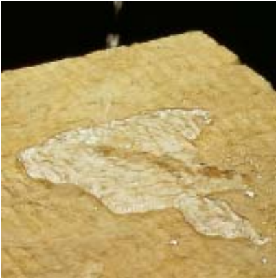
Wełna kamienna PAROC jest niekapilarna i nie pochłania wody
